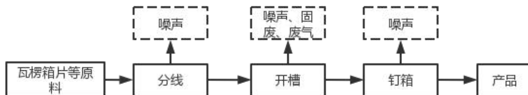
图 2-4 原有项目外包装箱工艺流程及产污环节示意图
