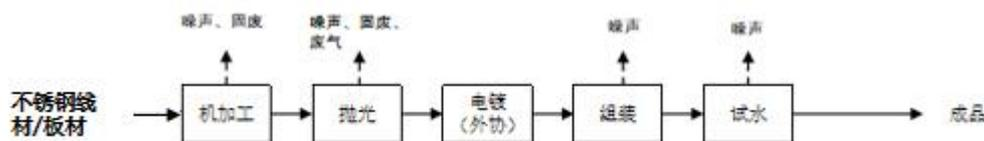
图 2-4 现有项目水龙头生产工艺流程及产污环节示意图
