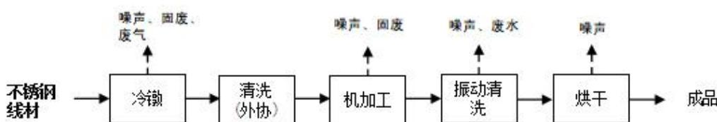
图 2-5 现有项目紧固件生产工艺流程及产污环节示意图
